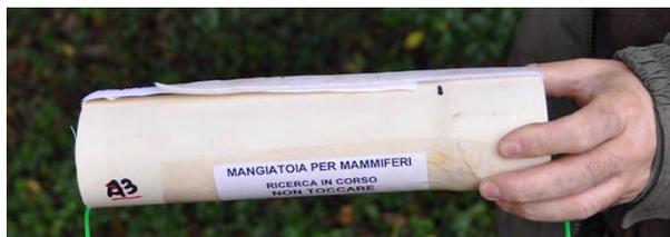
All'interno dei tubi viene posizionato un listello di legno su cui è stato messo un nastro biadesivo. Quando l'animale entra nel tubo, sfrega contro il nastro lasciandovi attaccati dei peli che possono essere prelevati per le successive analisi (*figura 2*).
